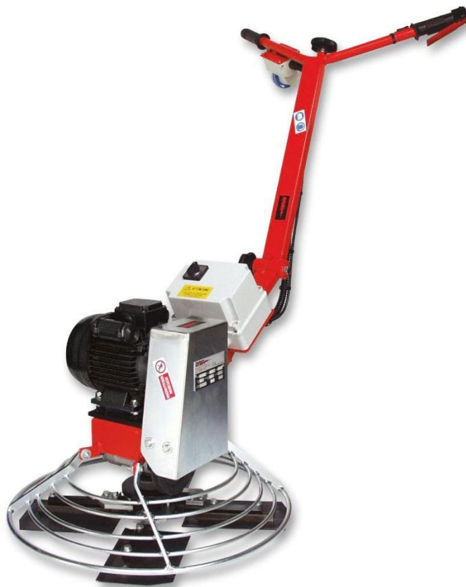
Helikopteri su građevinske mašine koje služe za glaćanje betona. Serija KE 75, bez štetnih emisija, je idealna mašina za rad u zatvorenom, za pripremu površina otpornih na habanje kao što su betonske podloge za polaganje drvenih podova, linoleuma i tepiha. Posebno je pogodna za rad u stanovima, garažama, na pločnicima i malim dvorišnim površinama.
