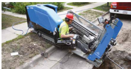
Jednostavno podešavanje ugla ulaska od 11° do 17°
